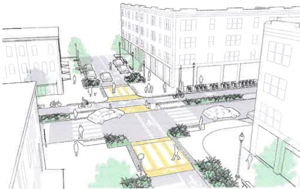
Fig. 89 Exemplo de sobrelevação de passadeiras (Fonte: Street Design Guide)
